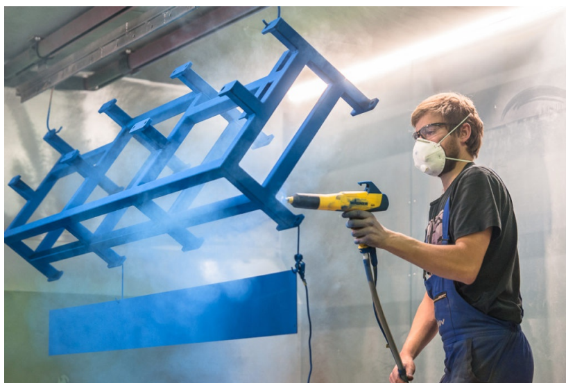
Obr. 21: Ukázka práškového lakování
