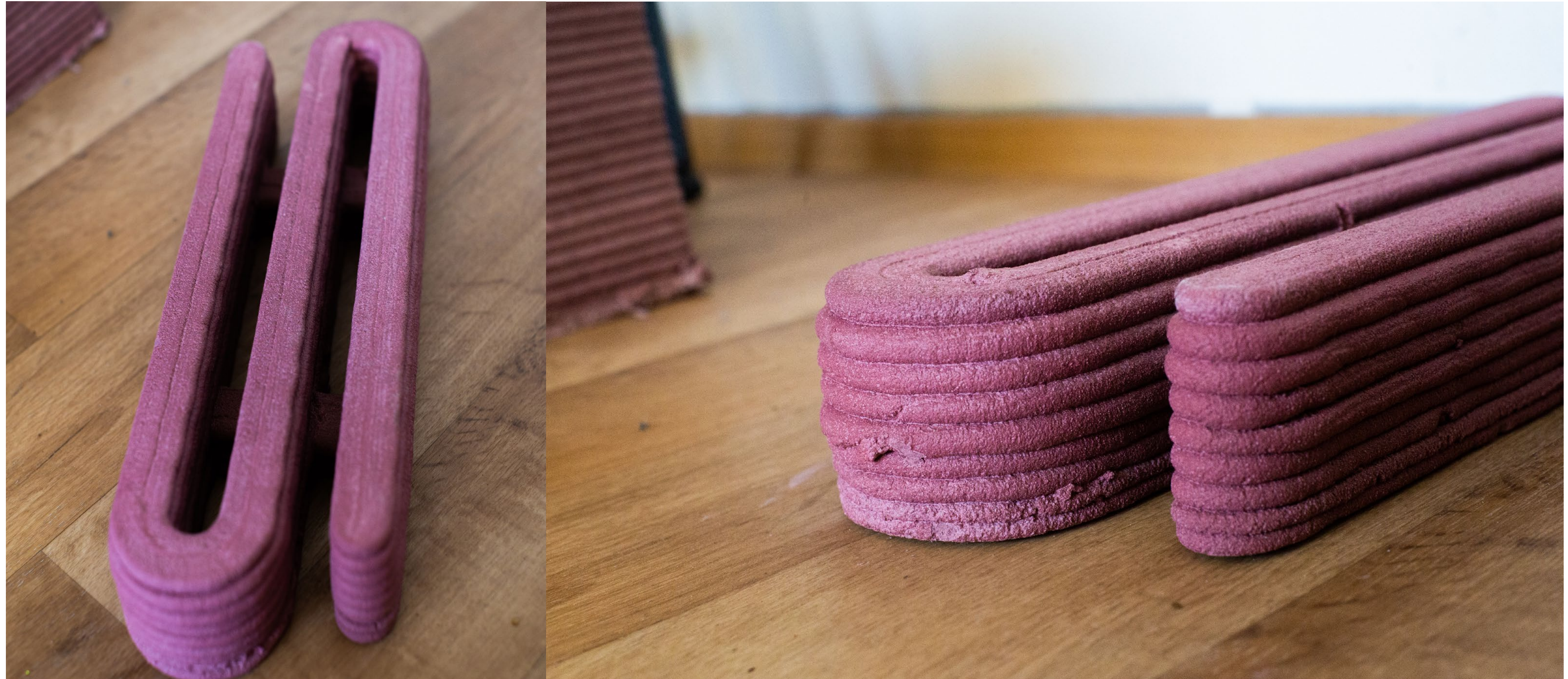
Barvený beton. 12mm tryska, 2 perimetry, 5mm vrstva
