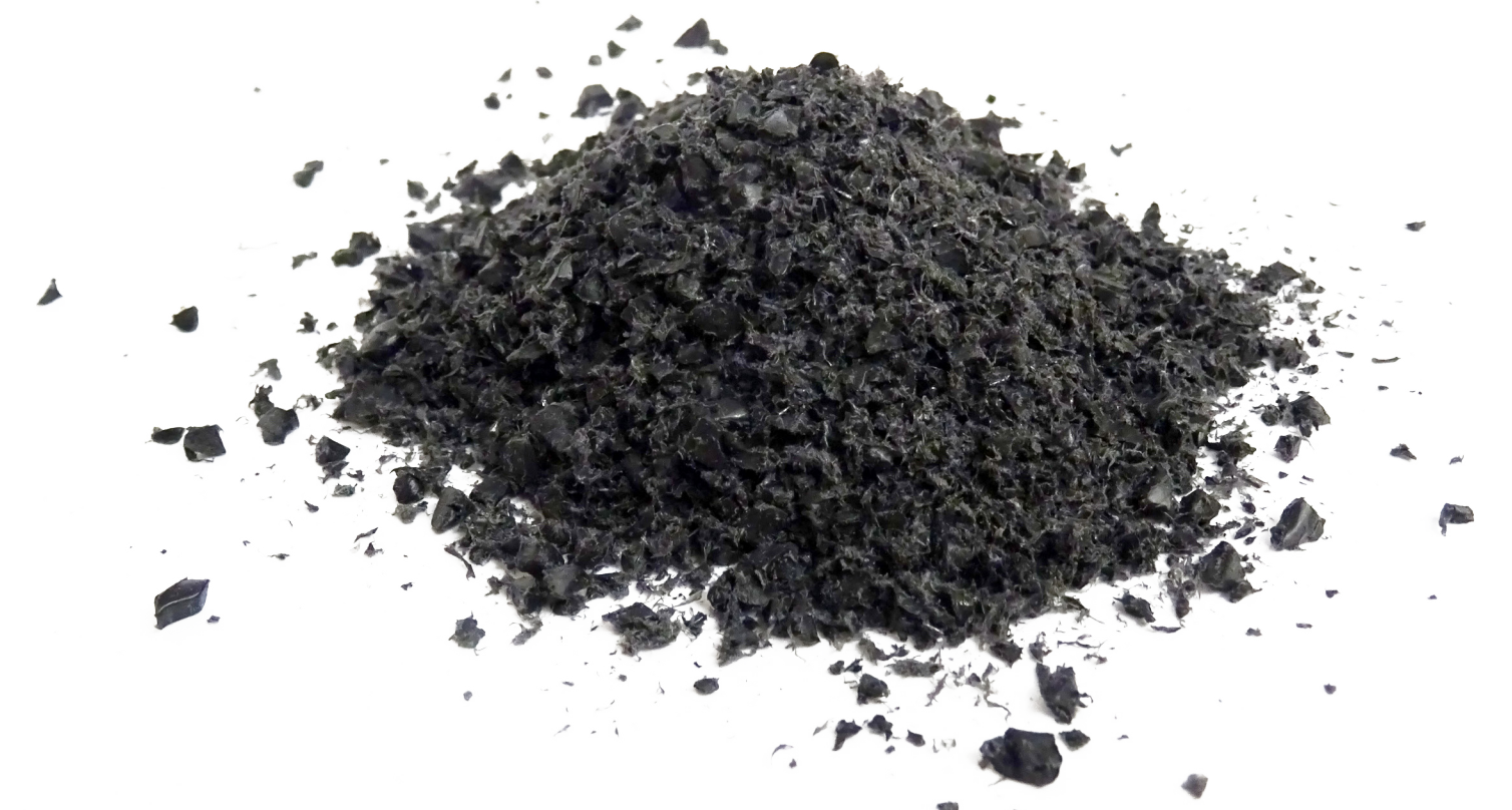
odpadový materiál / podrcený plast 2. jakosti
