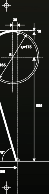
Pozn.: Zaoblení hran profilu A, d=2mm PROFIL A,C – RIGHT VIEW
